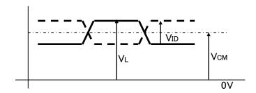
5) V<sub>CM</sub>: LVDS Common mode voltage (V<sub>CM</sub>=1.25V)
